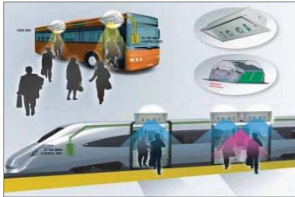
ภาพที่ 2 เทคโนโลยีทางด้านเซ็นเซอร์ในการตรวจนับจำนวนผู้โดยสาร ขึ้น-ลง
