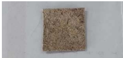
ภาพที่ 3 ชิ้นงานสำหรับทดสอบการหาค่าการซึมผ่านของน้ำและน้ำมัน
