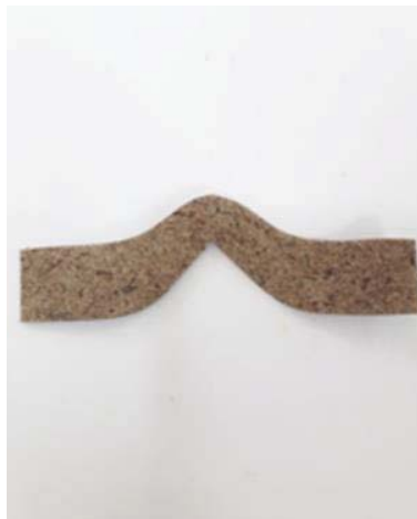
ภาพที่ 5 ชิ้นงานสำหรับทดสอบความต้านทานต่อการฉีกขาด
