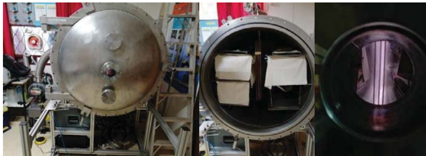
ภาพที่ 3 (ซ้าย) เครื่องปฏิกรณ์พลาสมาความถี่วิทยุแรงดันต่ำขนาดใหญ่ ของศูนย์วิจัยฟิสิกส์ของพลาสติกและล้าอนุภาค (กลาง) การติดตั้งชิ้นงานเพื่ออาบพลาสมา และ (ขวา) ภาพขณะอาบพลาสมา
