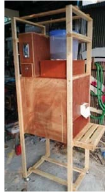
ภาพที่ 2 โครงสร้างเครื่องจำหน่ายอาหารปลาอัตโนมัติชนิดเม็ดแบบหยอดเหรียญ
