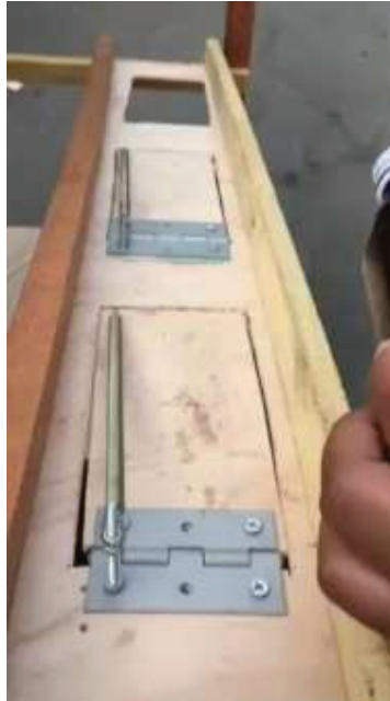
ภาพที่ 2 ลักษณะของรางทางลาดที่ใช้เป็นกลไกในการคัดแยกขยะบรรจุภัณฑ์ก่อนประกอบเป็นตู้
