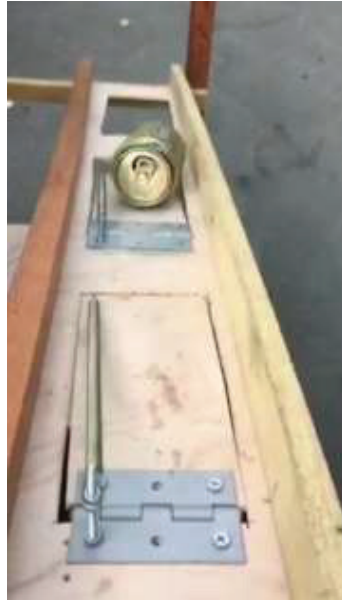
ภาพที่ 4 กระจบองอูลุมเนียมที่มีน้ำหนัคน้อยกว่า จะไหลผ่านช่องแรกไป และถูกแยกเป็นอันดับสอง ซึ่งจะถูกละการไหลผ่านรางทางลาดโดยบานพับ และหล่นลงไปนช่องที่ทำขนาดตามความยาวของกระจบองอูลุมเนียมโดยส่วนใหญ่
