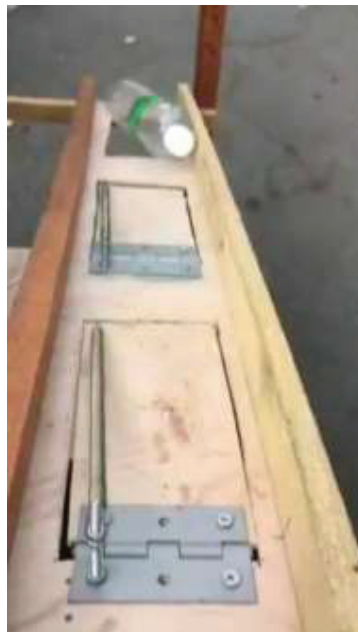
ภาพที่ 5 ขวดพลาสติกที่มีน้ำหนัคน้อย และมีความยาวมากกว่ากระจบองอูลุมเนียม จะไหลผ่านช่องแรกและช่องที่สองไป และถูกแยกเป็นอันดับสุดท้าย โดยหล่นลงไปนช่องที่ทำขนาดตามความยาวของขวดพลาสติกโดยส่วนใหญ่
