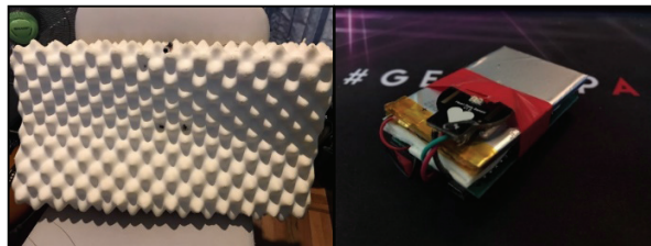
ภาพที่ 3 หมอนตรวจวัดเฉพาะบุคคลและอุปกรณ์รับข้อมูลอัตราการเต้นของหัวใจขณะนอนหลับ V.2 รุ่นทดลอง
